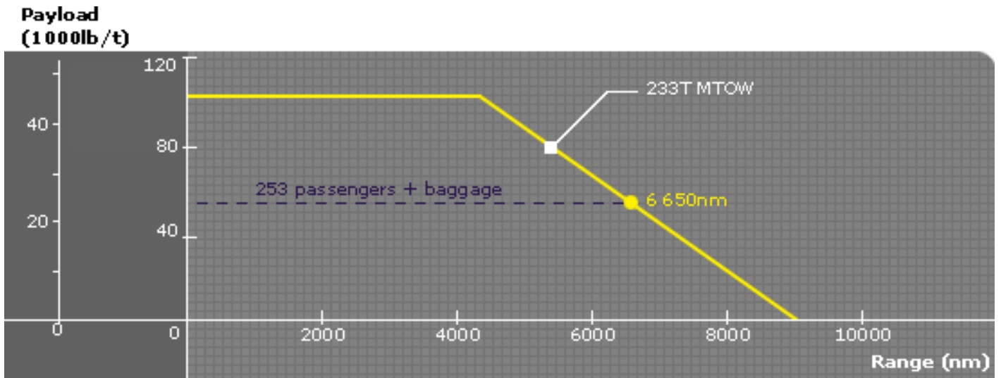
Figure 22 : rayons d'action maximaux en fonction du poids emporté au décollage de l'A330-200
